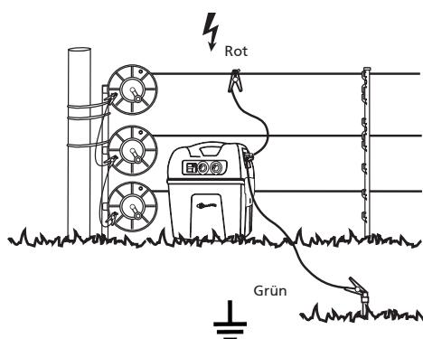
b. Schließen Sie die Zaunleitung mittels des mitgelieferten Sets mit der roten Leitung an die rote Ausgangsklemme des Elektrozaungeräts an. Der Draht muss gut am Zaundraht festgeklemmt sein.
