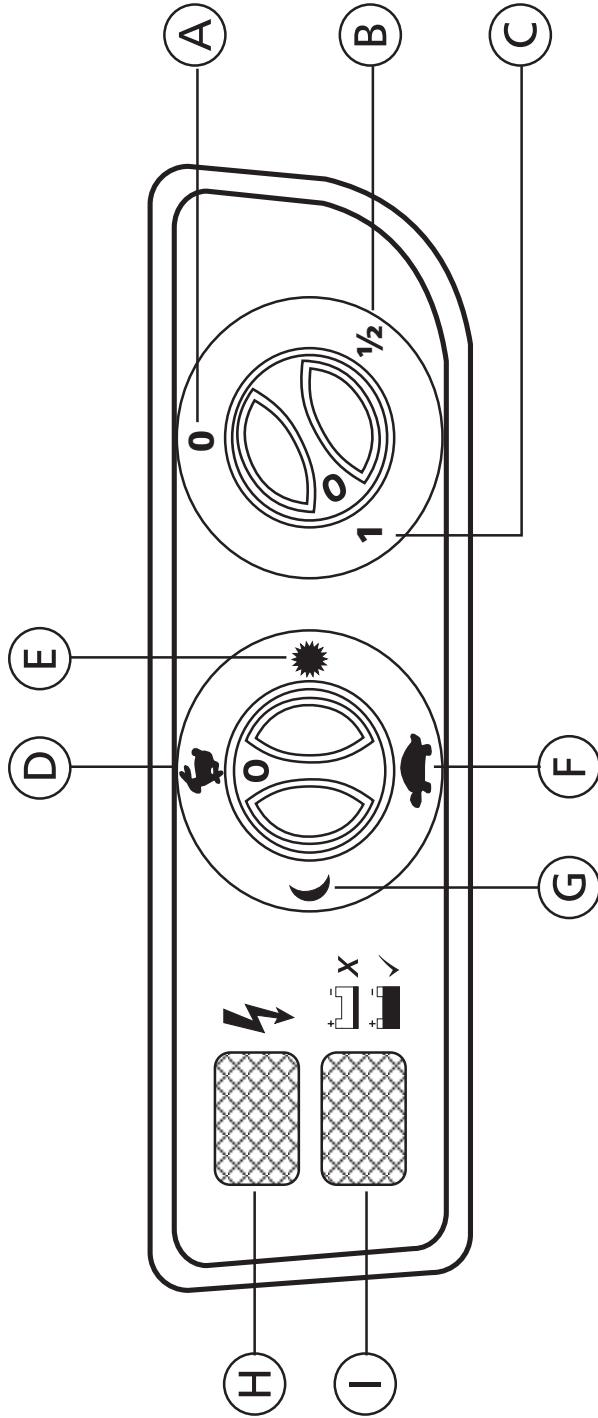
Para un funcionamiento óptimo de la batería, encienda el energizador a potencia media (B). Si el indicador rojo (H) no parpadea, encienda el energizador a potencia total (C) para así mantener el suficiente voltaje en la cerca.
